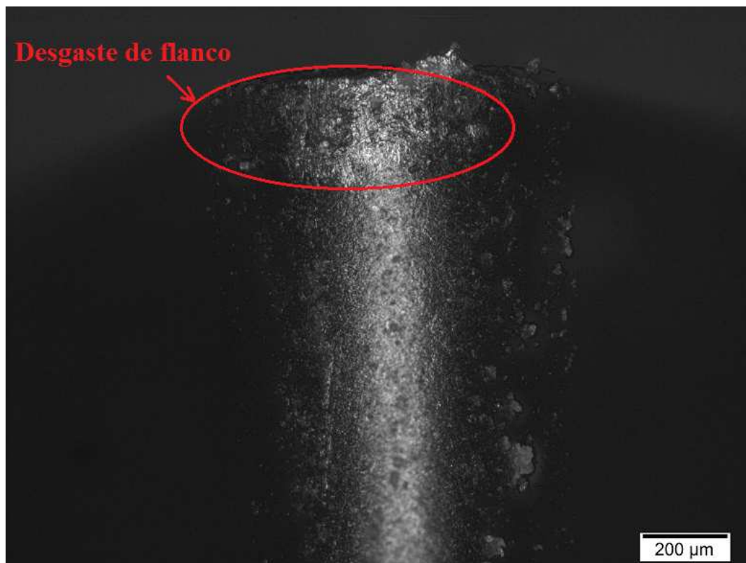
Figura 30: Desgaste de flanco após 480 mm usinados à velocidade de 30 m/min.
