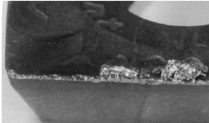
Figura 11: Mecanismo de desgaste por adesão (Stoeterau, 2004).
